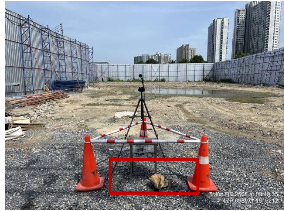
ภาพที่ 29 ติดตั้งเครื่องตรวจวัดระดับความสั่นสะเทือน
